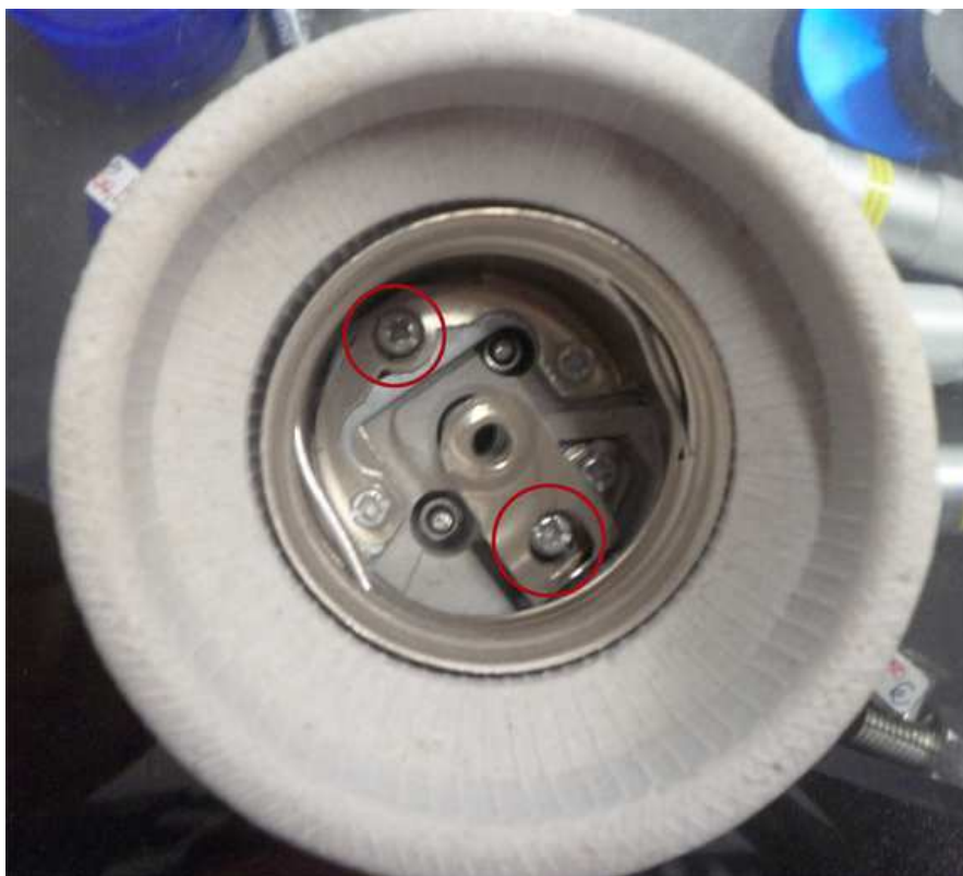
Tornillos que debemos aflojar al meter la mano por el tubo
